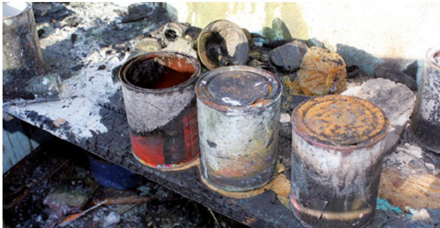
nalazila otvorena limena kutija sintetičke lakozapaljive tekućine (emaj-laka) koja se zapalila zbog visoke temperature i dodatnog akumuliranja topline u skućenom prostoru između drvene police i samog krovista.
